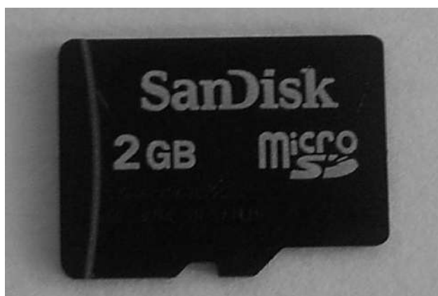
Рисунок 20 – внешняя карта памяти формата micro SD для монитора двигателя МД-4М.
